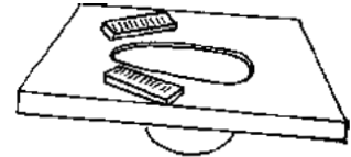
Trampa de sello hidráulico colocada en la losa de concreto
